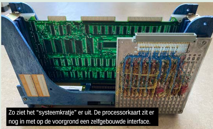
I/O module van Intel en twee kaarten met eigen elektronica erop. Heel veel werk ging zitten in het wirewrappen met diverse kleuren draad om de kluts niet volledig kwijt te raken.
