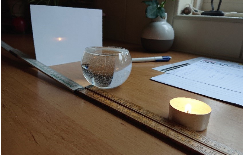
Het bepalen van de brekingsindex van water
