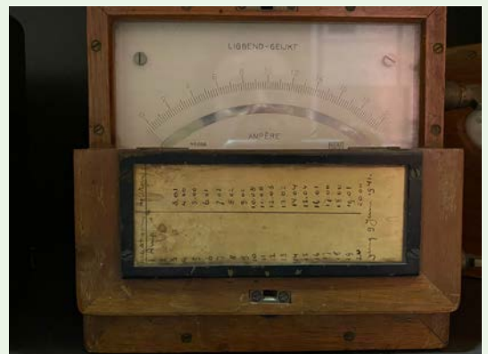
Waarschijnlijk zelfbouw meters met de beroemde kabinet nummers. Let op de kortgesloten meet polen. De meters waren zeer gevoelig en konden slecht tegen vervoer. Om de naald te dempen, werden de polen kortgesloten.
