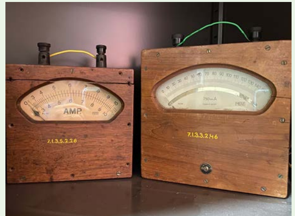
Waarschijnlijk zelfbouw meters met de beroemde kabinet nummers. Let op de kortgesloten meet polen. De meters waren zeer gevoelig en konden slecht tegen vervoer. Om de naald te dempen, werden de polen kortgesloten.
