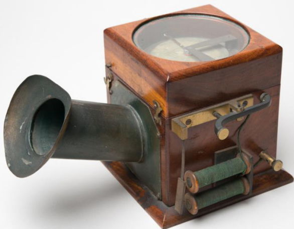
Een Reiss-telefoon. Alexander Graham Bell baseerde zijn patent uit 1876 onder andere op de ideeën van Philipp Reiss (1834-1874), die ook het woord 'telefoon' introduceerde.
