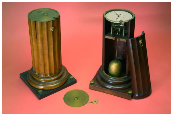
Links een instrument voor het demonstreren van de parabolische valbeweging. Hierboven zie je een tertiënhorloge; deze 19e eeuwse stopwatch werd in 1823 gebruikt bij de experimenten van Moll en Van Beek om de snelheid van het geluid te bepalen.
