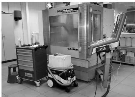
Deze machine kan met ultrasone techniek koud glas en keramiek met hoge nauwkeurigheid bewerken
