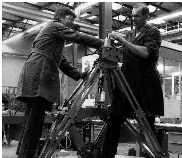
Rob Hammerschlag en Piet Hoogendoorn, staande op het declinatietandwiel (in de werkplaats van TU Delft) dat op z'n kop ligt om de ondersteuning te monteren
