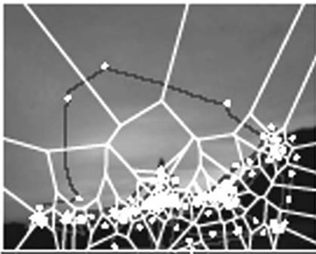
Indeling in Voronoi-cellen op basis van de fixaties (witte stippen) bij het vrij bekijken van een afbeelding
